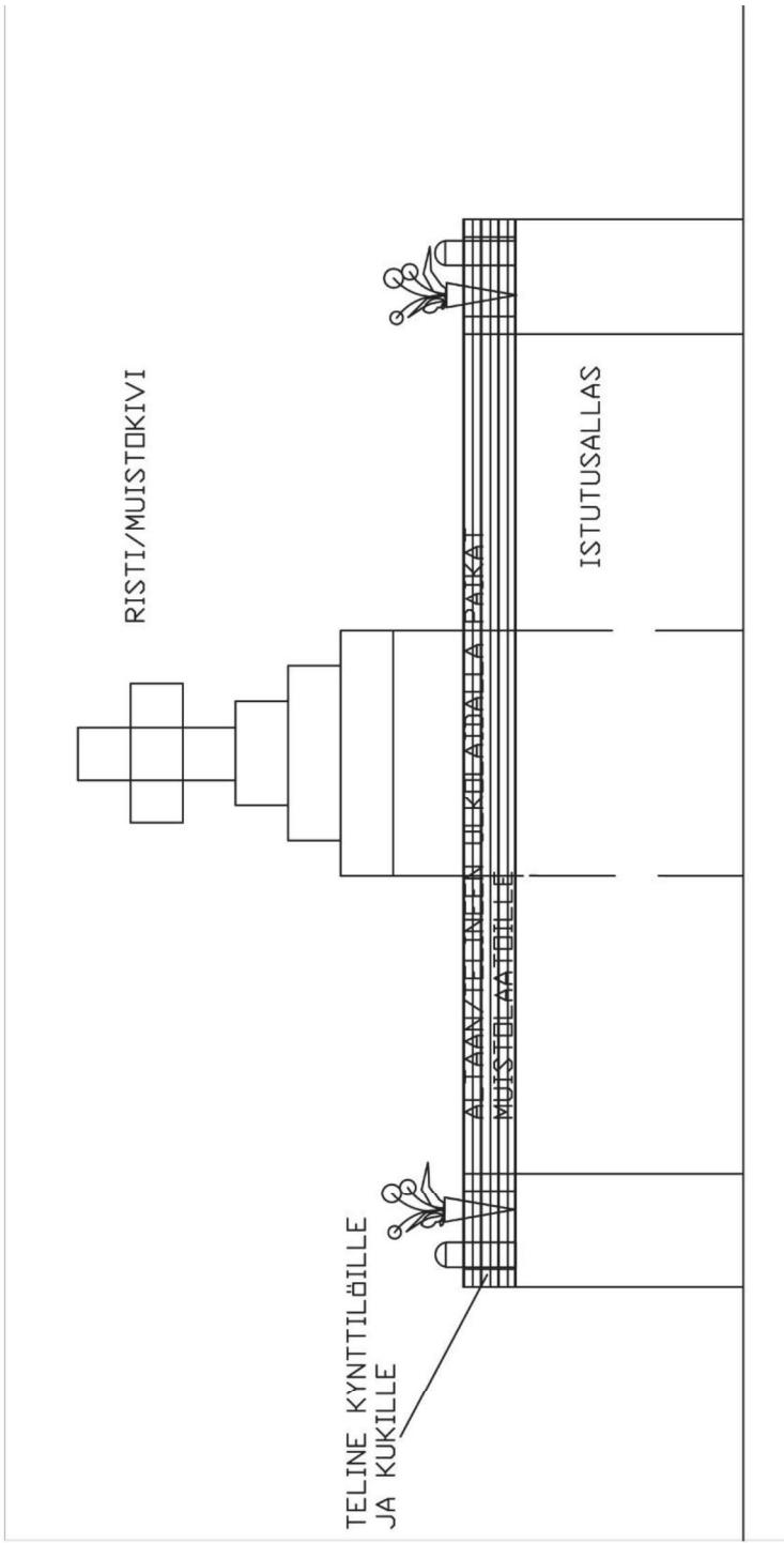
Kuva 22. Keskelle sisäpihaa rakennetaan betonista valkeaksi maalattu 6-kulmainen allas, jonka reunaa kiertää musta esim. metallista rakennettu kehikko hautakynttilöitä ja – kulkamajakoita varten. Nykyinen pieni kiviristi kiinnitetään kivijalustalle, korokkeelle, keskelle allasta. Altaan kynttilä-ja kukkateelineen ulkolaidalle on mahdollista kiinnittää niiden tuhkahaudattujen muistolaatat, jotka eivät ole halunneet omaa hautapaikkaa.
